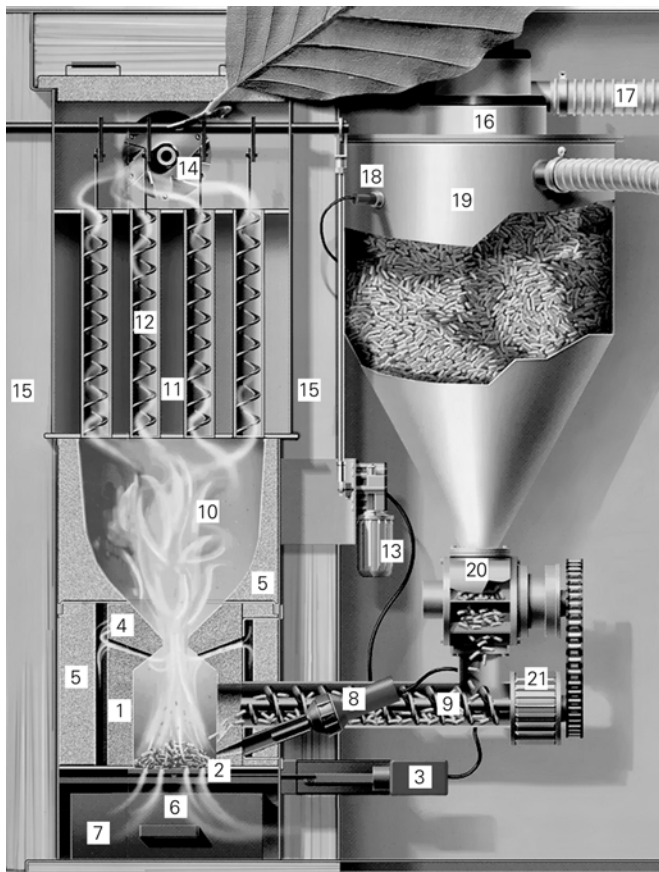
Abbildung 14 Pelletkessel mit integriertem Zwischensilo, das pneumatisch ab Silo beschickt wird. Beschickung über Schnecke von oben auf eine Retorte bzw. Rost (Hargassner).
