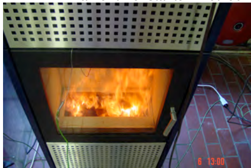
Bild 9 Flammenbilder Ofen 3. Links nach der Anfeuerphase, rechts bei Betriebstemperatur.
