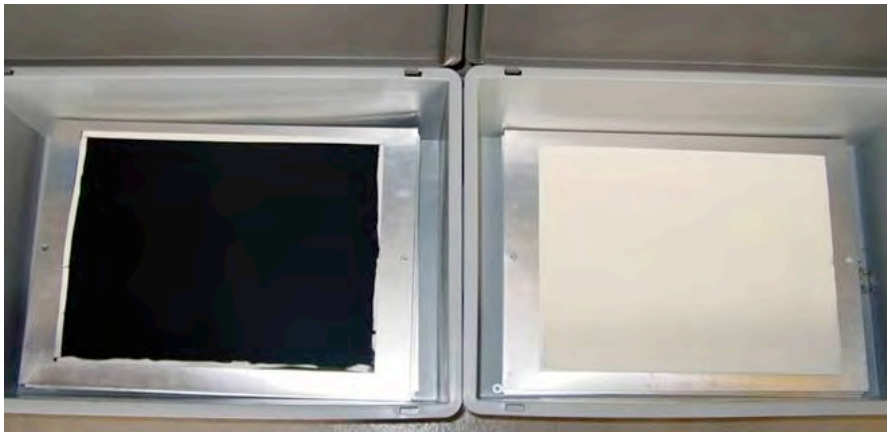
Bild 14 Filterproben von einem Dieselmotor (links) und einer automatischen Holzfeuerung (rechts).
