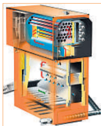
Bild 2: Rostfeuerung. Bild: Schmid
