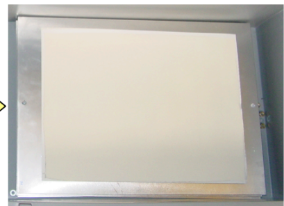
Filter beladen mit 2 g Feinstaub (vorwiegend Salze)
