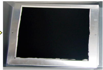
Filter beladen mit 0,5 g Feinstaub (Dieselruß)
